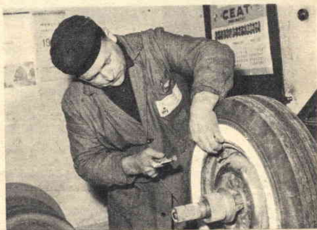
Fig. 2 - Constatata con la macchina la squilibratura della ruota, si applicherà il piombo necessario nella grammatura e nella posizione del cerchio indicato dal quadrante della macchina stessa.
